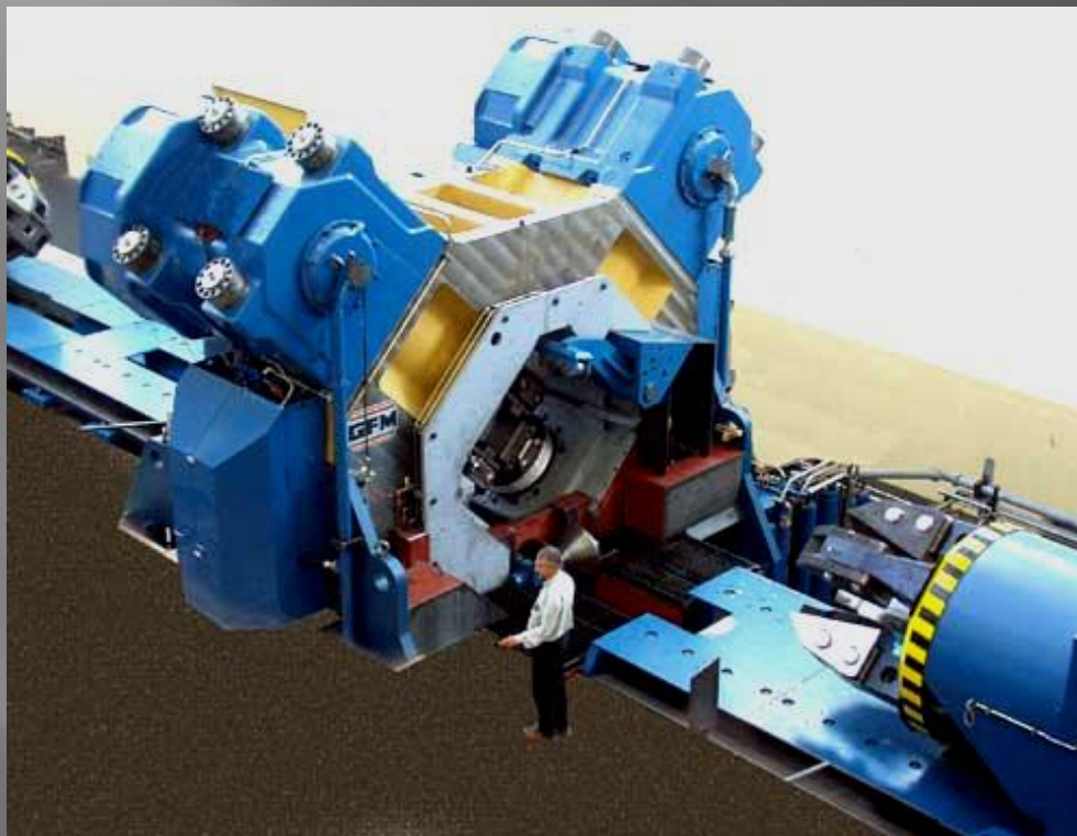
Slika 6.21 Radijalna kovačka mašina, model RF-45 GFM (Austrija) [72]
