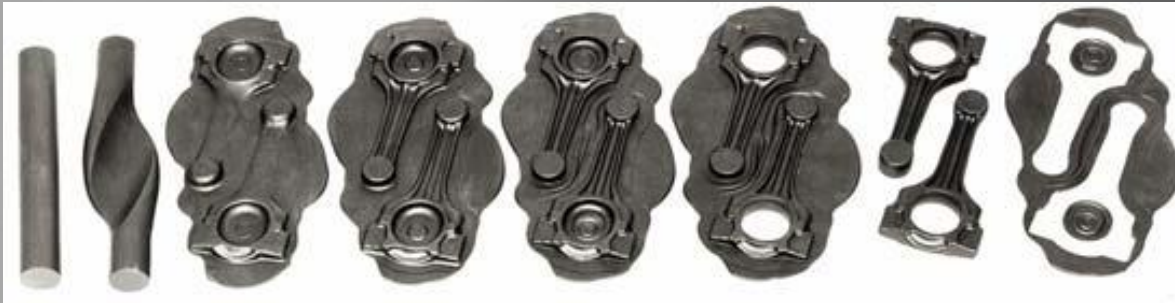
Slika 6.5 Venac otkivka kovanog u otvorenom kalupu
